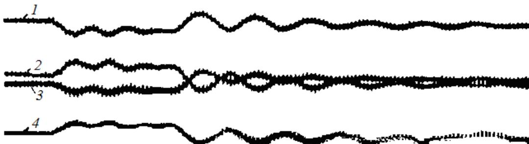
**Рис. 1** – Осциллограмма аварийной остановки клеток в середине ствола многоканатной подъемной установки
