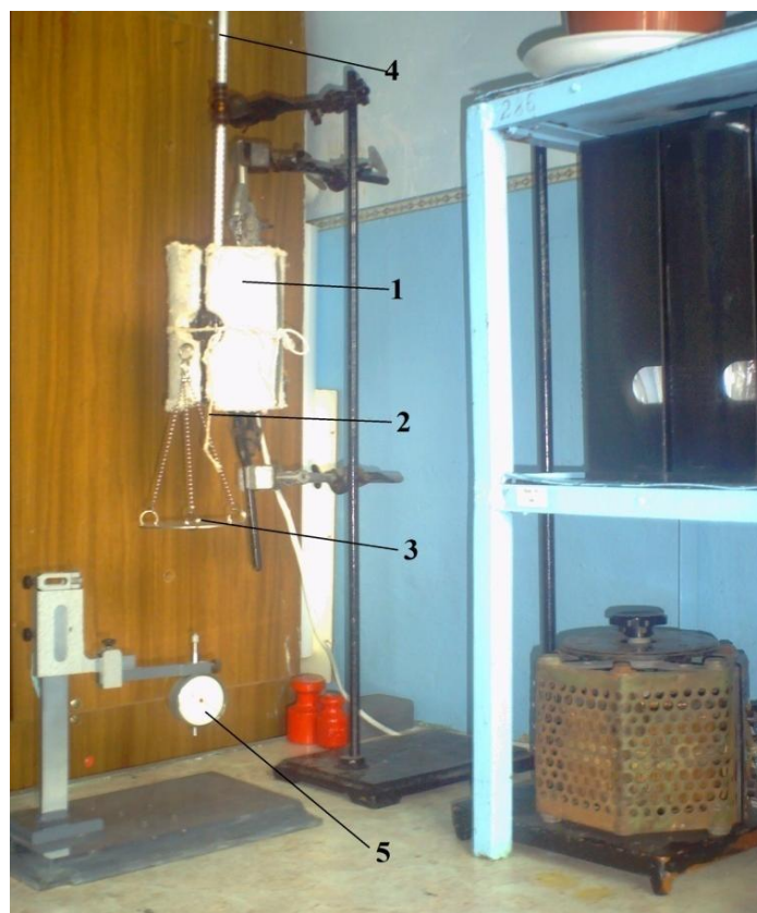
Рис. 1 – Експериментальна установка по визначенню термомеханічних характеристик
