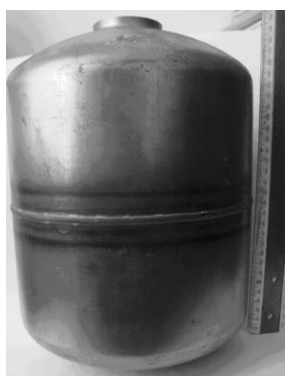
Рис. 11 – Изделие «Баллон», сваренное из двух полученных деталей
