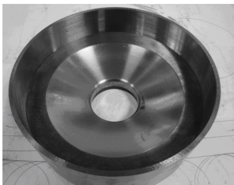
Рис. 9 – Матрица а) и пуансон б) для отбортовки
