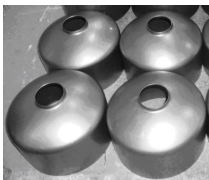
Рис. 10 – Отбортованные составные детали изделия «Баллон»
