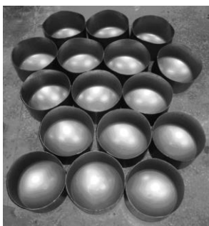
Рис. 8 – Заготовки, полученные вытяжкой
