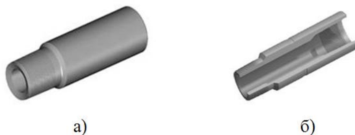
Рис. 1 – Зовнішній вигляд (а), поздовжній перетин переводника (б)
