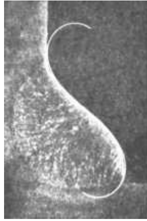
Рис. 1- Сравнение реальной и теоретической формы углового шва
